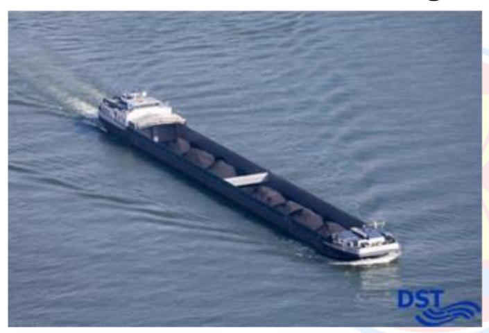
Bulk carrier: CMS AMIGOS, L: 135 m – B: 11.45 m – D: 3.60 m – T: 3922 t – P: 2x1020kW + 290kW
